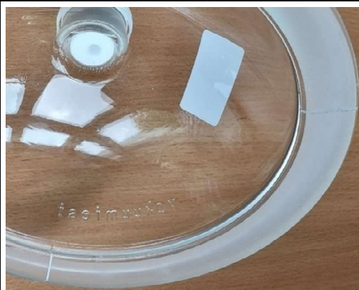
Figur 2. Undersida exsickatorlock med fräst spår enligt beskrivning. Källa: Eurofins Pegasuslab
